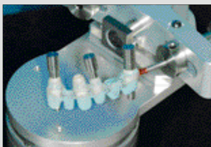
27. ... Ici se fait le scannage du contour de l'armature, puis des marqueurs de position des implants sur le modèle.
